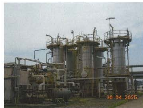
ภาพที่ 2-13 หน่วย Dehydrator (ใช้ร่วมกันกับ PP1)
